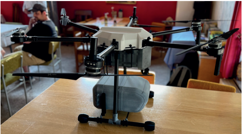
Die Drohne, die für die Testphase eingesetzt wird, wurde gezeigt. Das Öffnen des Laderaums (max. 3 kg) konnte bei dieser Gelegenheit geübt werden.
